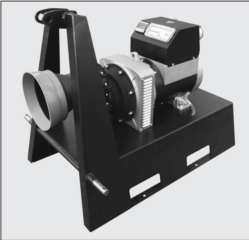
Synchron-Generator mit Übersetzungsgetriebe für Zapfwellenantrieb über Traktor. Antriebsdrehzahl 430 n 4-poliger Synchron-Generator mit Voltmeter, Amperemeter und Frequenzanzeige, 2 Steckdosen mit Sicherungen, FI-Schutzschalter, fertig auf Metallrahmen mit 3-Punkt-Aufnahme für die Ackerschiene. IP 54
